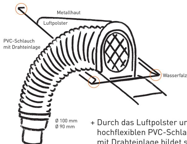
+ Durch das Luftpolster um den hochflexiblen PVC-Schlauch mit Drahteinlage bildet sich nur wenig Tauwasser.
