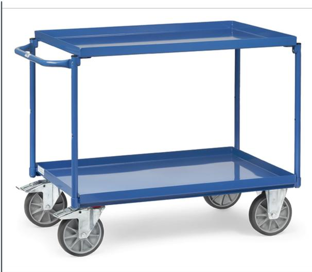
Stahlkonstruktion, geschweißt. Mit 2 Stahlblechwannen. Stahlrohrbügel und Stahlblechwannen verschraubt. Wannen öldicht, Rand 40 mm hoch. Pulverbeschichtet brillantblau RAL 5007. Schiebegriff waagrecht. 2 Lenk- und 2 Bockrollen, TPE-Bereifung, Naben mit Rillenkugellager. Feststeller an den Lenkrollen, gemäß EN 1757-3 (Sicherheit von Plattformwagen). Tragkraft obere Ladefläche 200 kg.
