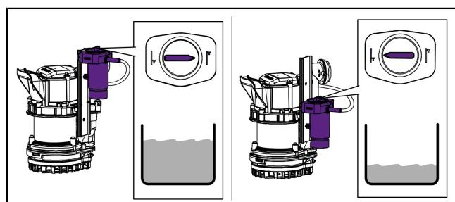
Modifier la position de l'interrupteur à flotteur
