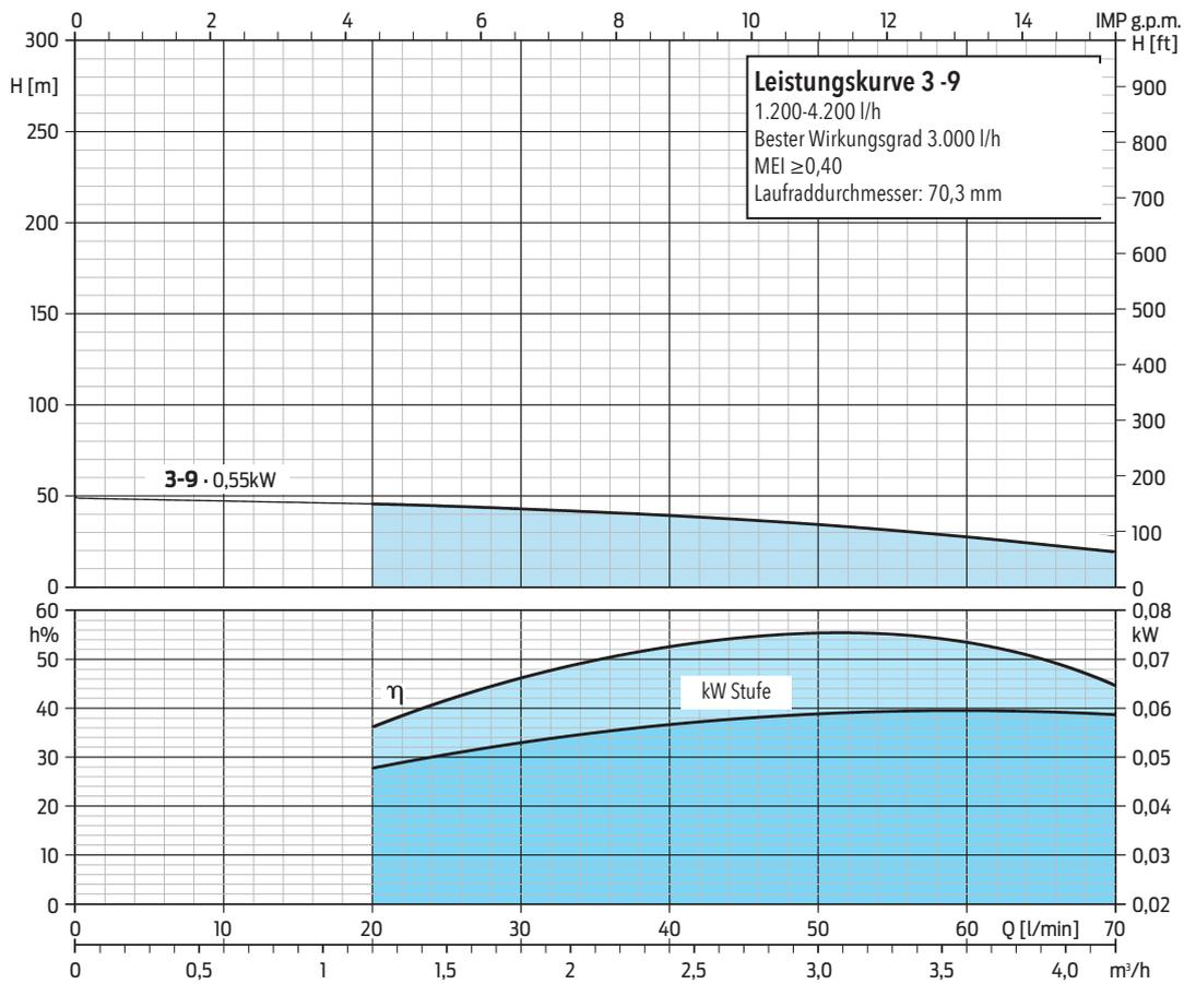
• 4" NEMA Standardabmessungen • Leistungskurven bei: 2850 min<sup>-1</sup> • Leistungsspitze gemäß ISO 9906 - Anhang A Produktion Serienpumpen.
