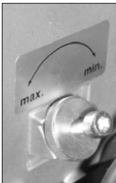
Durch die Verstellung der Luftklappe wird die Verbrennungsluft an die Ölmenge (Leistung) angepasst. Der Luftüberschuss - gemessen als CO<sub>2</sub>- oder O<sub>2</sub>-Anteil in den Verbrennungsabgasen - wird über die Luftklappe mit einem geeigneten Emissionsmessgerät an die Vorgaben in der Grundeinstellwerte aus Absatz 4.3.8 angepasst.
