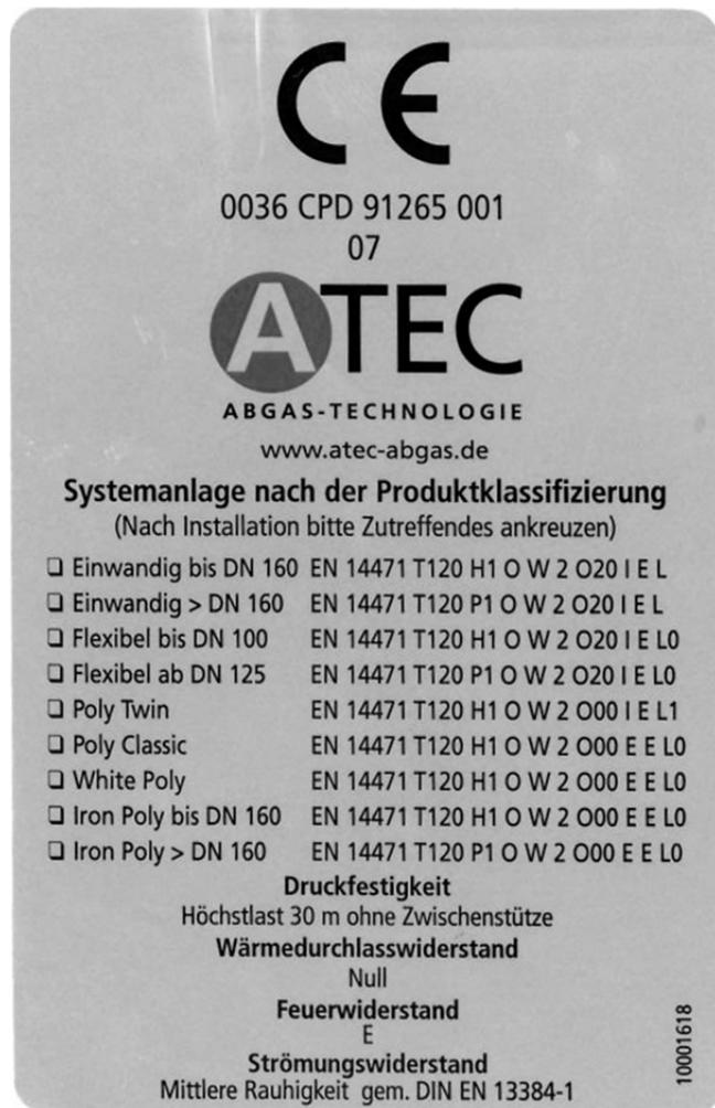
Abb. 60: Kennzeichnungsaufkleber
