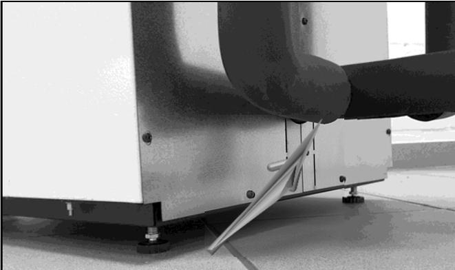
Abb. 12: Vorgestanzter Ausschnitt in der Kesselrückwand
