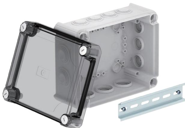
Kabelabzweigkasten zum Verbinden von Kabeln und Leitungen im Innenbereich und geschützten Außenbereichen. Rechteckige Form mit Einsteckdichtungen an den Seiten und Ausschlageneinführungen im Boden. Geeignet für die Wand-/ Deckenmontage und die Montage auf Montageblechen. Mit der Möglichkeit zur Innenbefestigung und Montage über die Eckdome. Hoher, transparenter Deckel mit Schnellverschluss, plombierbar. Hergestellt aus halogenfreien Materialien.
