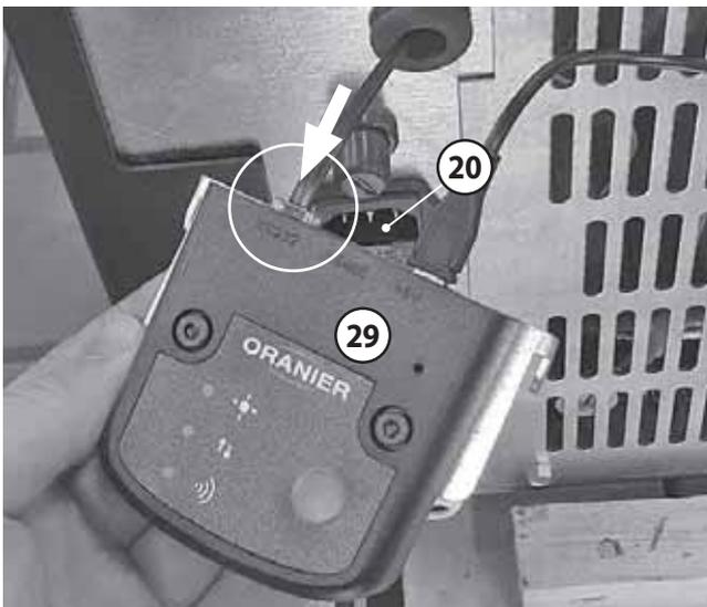
Schließen Sie die Stromversorgung an das **Wi-Fi-Modul (29)** an.
