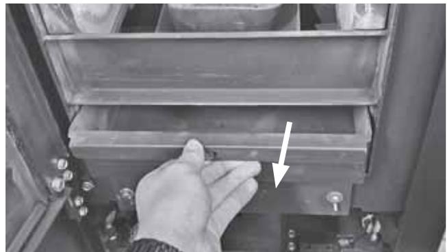
Der **Aschenkasten (6)** ist mindestens jeden zweiten bis dritten Betriebstag zu kontrollieren und ggf. zu entleeren!
