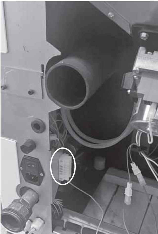
Diese **Lüsterklemmleiste** wird erreichbar, wenn das untere **Abdeckblech** an der Rückseite des Gerätes entfernt wird.
