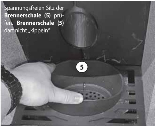
Spannungsfreien Sitz der **Brennerschale (5)** prüfen. **Brennerschale (5)** darf nicht „kipeln“
