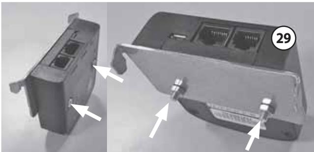
Schließen Sie das **Wi-Fi-Modul (29)** an das Gerät an. Das Anschlusskabel befindet sich in einer Kabeldurchführung an der Rückseite des Geräts in der Nähe des **Netzanschlusses (20)**.
