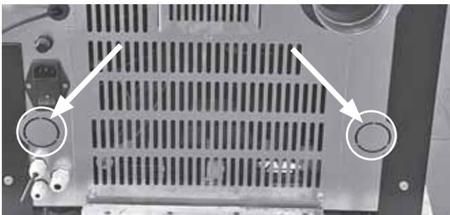
Durch die so geschaffenen Öffnungen können gerade Rohre bis zu den **Anschlüssen Rücklauf (33)** und **Vorlauf (32)** im Gerät verlegt werden.
