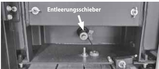
Über einen an den **Entleerungsschieber** angeschlossenen Schlauch kann das im Geräteessel befindliche Wasser abgeleitet werden.
