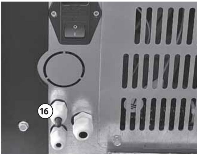
Die vom **Raumtemperaturfühler (16)** gelieferten Temperaturwerte sind sehr wichtig für eine effektive Steuerung des Gerätes im Betrieb.
