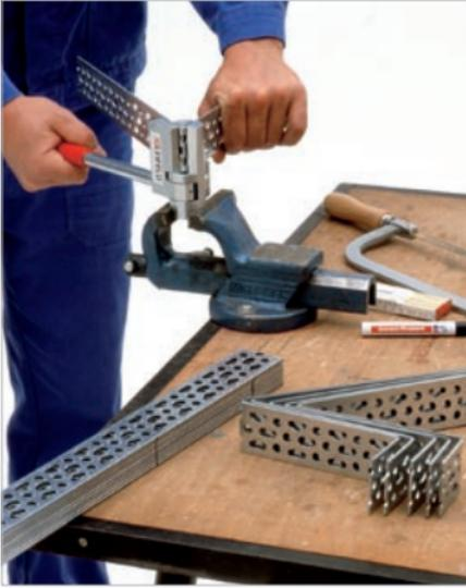
Bei der Fertigung einer Wandkonsole müssen Sie einen Winkel von  $135^\circ$  biegen. Dieses erreichen Sie, wenn Sie die Biegezan-ge in den Schraubstock spannen oder den linken Griff der Biegezan-ge versetzen!
