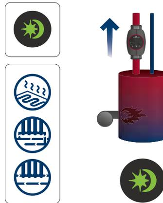
Abb. 31 Automatische Nachtabsenkung aktiviert
