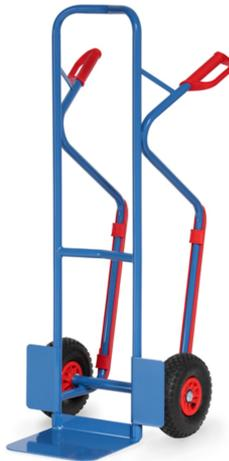
Stahlrohr-Stapelkarre mit Stahlblechschaufel, stabile Schweißkonstruktion, pulverbeschichtet blau RAL 5007. fetra Sicherheitsgriffe. Stahlblechschaufel anschraubbar und dadurch austauschbar. Mit auswechselbaren Kunststoff-Gleitkufen. Räder mit Luftbereifung, auf Kunststoff-Felgen, Naben mit Rollenlagerung. Bügel oben und Querstreben durchgebogen. Für den sicheren Transport von runden Gütern, wie Rollen, Kannen, Eimern usw. Zerlegte Anlieferung.
