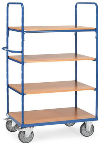
Baukasten-System: Aus Stahlrohr und Profilstahl geschweißt, pulverbeschichtet blau RAL 5007, Schraubkonstruktion. Stirnwände offen. 1 fester und 3 lose Einlegeböden aus Holzwerkstoffplatten, Oberfläche Buchendekor. Einlegeböden variabel einsetzbar, Teilung 100 mm. Tragkraft pro Einlegeboden 90 kg. 2 Lenk- und 2 Bockrollen, TPE-Bereifung, Naben mit Rillenkugellager. Feststeller an den Lenkrollen, gemäß der Europäischen Norm EN 1757-3 (Sicherheit von Plattformwagen).
