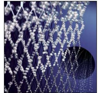
Die Mikroblasen verbinden sich zu größeren Blasen, bis der hydrostatische Schub größer wird als die Kraft, die sie an der Struktur haften lässt. Diese Blasen steigen nach oben und werden über ein automatisches Entlüftungsventil mit Schwimmer (2) abgeschieden. Dabei spielt dank der Bauweise die Strömungsrichtung des Mediums keine Rolle.
