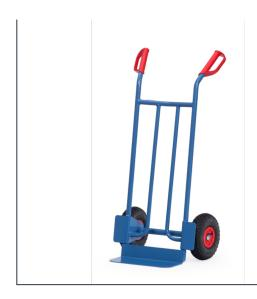
Stahlrohr-Sackkarre mit Stahlblechschaufel, stabile Schweißkonstruktion, pulverbeschichtet, blau, RAL 5007. fetra Sicherheitsgriffe. Stahlblechschaufel anschraubbar und dadurch austauschbar. Räder mit Luftbereifung, auf Kunststoff-Felgen, Naben mit Rollenlagerung. Zerlegte Anlieferung.
