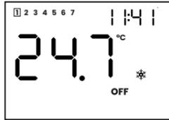
Das Display zeigt OFF, Uhr und Raumtemperatur an. Die Frostschutzfunktion ist aktiv.
