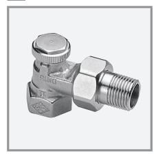
Heizkörper-Rücklaufverschraubung zum Absperren und Regulieren. Betätigung des Absperr-/Regulierkegels mit Sechskantstiftschlüssel SW 5.
