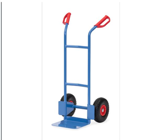
Handlich Stapelkarre mit Stahlblechschaufel, stabile Schweißkonstruktion, pulverbeschichtet blau RAL 5007. fetra Sicherheitsgriffe. Stahlblechschaufel anschraubbar und dadurch austauschbar. Räder mit pannensicherer PU-Bereifung auf Kunststoff-Felgen, Naben mit Rollenlagerung. Bügel oben und Querstreben durchgebogen. Für den sicheren Transport von runden Gütern, wie Rollen, Kannen, Eimern usw. Zerlegte Anlieferung.
