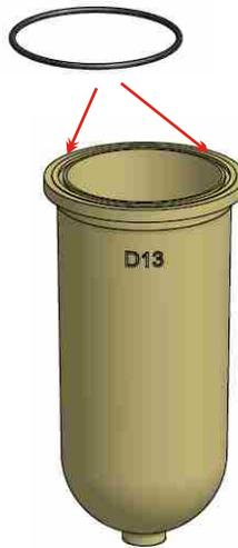
O-Ring in die Aufnahme der Filtertasse einlegen und Filtertasse mit Filterkopf verbinden. **ACHTUNG:** sicherstellen, dass der O-Ring richtig in der Führung liegt!
