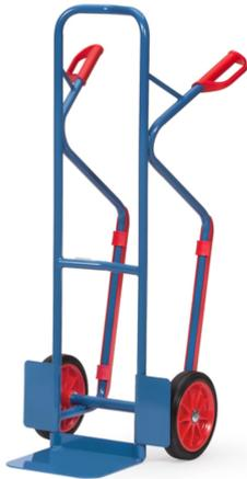
Stahlrohr-Stapelkarre mit Stahlblechschaufel, stabile Schweißkonstruktion, pulverbeschichtet, blau, RAL 5007. Sicherheitsgriffe. Stahlblechschaufel anschraubbar und dadurch austauschbar. Mit auswechselbaren Kunststoff-Gleitkufen. Räder mit Vollgummibereifung, auf Kunststoff-Felgen, Naben mit Rollenlagerung. Bügel oben und Querstreben durchgebogen. Für den sicheren Transport von runden Gütern, wie Rollen, Kannen, Eimern usw. Zerlegte Anlieferung.
