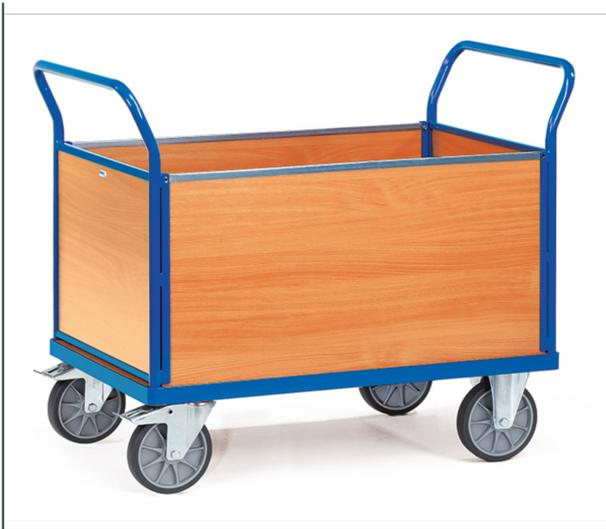
Stahlrohr und Profilstahl geschweißt, pulverbeschichtet RAL 5007, Plattform Holzwerkstoffplatte, Oberfläche Buchendekor. 2 Stirnwände und 2 Längswände aus Holzwerkstoffplatte, Oberfläche Buchendekor, Wände 500 mm hoch. 2 Lenk- und 2 Bockrollen, TPE-Bereifung, Naben mit Rillenkugellager. Feststeller an den Lenkrollen, gemäß der Europäischen Norm EN 1757-3 (Sicherheit von Plattformwagen).
