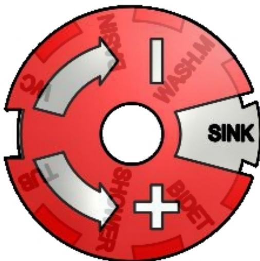
**Abb. 2:** Beispiel für die Positionierung des Anzeigers für einen Ausgang Warmbrauchwasser für ein Waschbecken.
