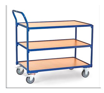
Leichter Tischwagen aus Stahlrohr und Profilstahl geschweißt, pulverbeschichtet brillantblau RAL 5007. Schraubkonstruktion. 3 Böden aus Holzwerkstoffplatte, Oberfläche Buchendekor, im Stahlrahmen liegend mit 12 mm hohen Rand. Schiebegriff hochstehend. 2 Lenk- und 2 Bockrollen, TPE-Bereifung, Naben mit Rillenkugellager. Feststeller an den Lenkrollen, gemäß der Europäischen Norm EN 1757-3 (Sicherheit von Plattformwagen). Tragkraft obere und mittlere Ladefläche 80 kg.
