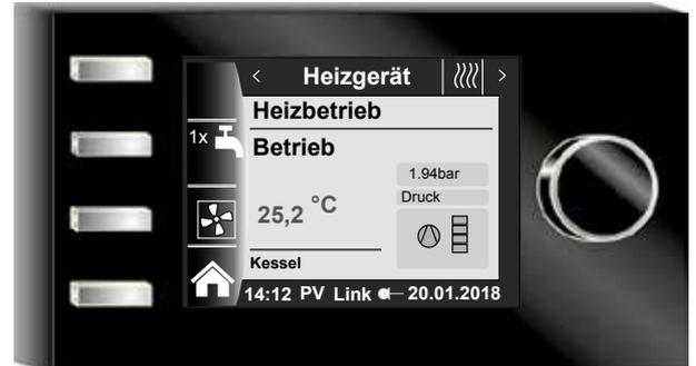
Das BM-2 (Bedienmodul) kommuniziert über eBus mit allen angeschlossenen Erweiterungsmodulen und mit der Luft/Wasser-Wärmepumpe.
