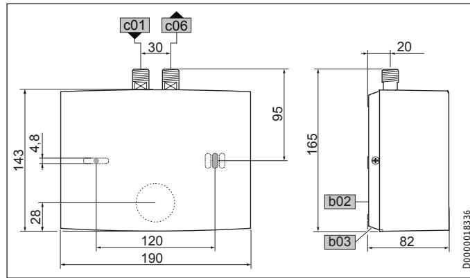
b02 Doorvoer elektrische kabels I
