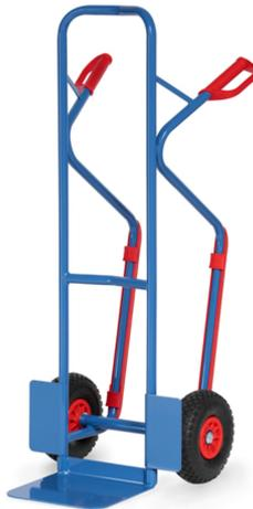
Stahlrohr-Stapelkarre mit Stahlblechschaufel, stabile Schweißkonstruktion, pulverbeschichtet blau RAL 5007. fetra Sicherheitsgriffe. Stahlblechschaufel anschraubbar und dadurch austauschbar. Mit auswechselbaren Kunststoff-Gleitkufen. Räder mit pannensicherer PU-Bereifung, auf Kunststoff-Felgen, Naben mit Rollenlagerung. Bügel oben und Querstreben durchgebogen. Für den sicheren Transport von runden Gütern, wie Rollen, Kannen, Eimern usw. Zerlegte Anlieferung.
