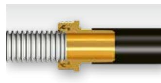
Bei leicht gelockerter Verschraubung wird das sauber mit Rohrschneider gratfrei abgeschnittene Edelstahlwellrohr in den Fitting geschoben, die Überwurfmutter wird in Folge angezogen: Fertig!
