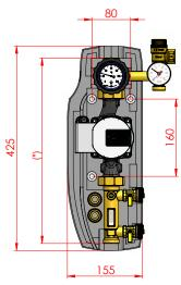
(\*) Distanzgewindeanschlüsse: 22 mm Klemmverschraubung: 405 mm 3/4" AG und 1" AG: 385 mm
