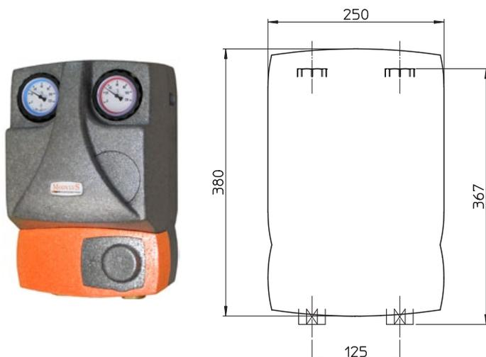
MODVLVS Energy Heizkreisset ist geeignet für die Messung von Energie bei Heiz- und Kühlungsanlagen. Dank der Verwendung von 2 Kugelhähnen im Rücklauf ermöglicht es eine einfache Montage des Wärmehählers (WZ). Der zweite Fühler ist direkt im Vorlauf-Kugelhahn eingesetzt, ohne Hilfe von Adapter oder zusätzlicher Tauchhülse
