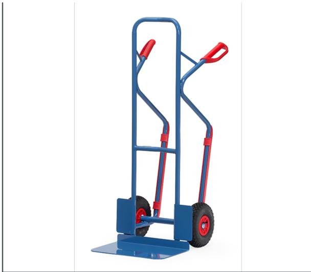
Stahlrohr-Stapelkarre mit Stahlblechschaufel, stabile Schweißkonstruktion, pulverbeschichtet blau RAL 5007. Sicherheitsgriffe. Stahlblechschaufel anschraubbar und dadurch austauschbar. Mit auswechselbaren Kunststoff-Gleitkufen. Räder mit Luftbereifung, auf Kunststoff-Felgen, Naben mit Rollenlagerung. Bügel oben und Querstreben durchgebogen. Für den sicheren Transport von runden Gütern, wie Rollen, Kannen, Eimern usw. Zerlegte Anlieferung.
