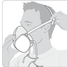
1. Maske über Mund und Nase setzen und Kopfbebänderung gemäß Abbildung anlegen.
