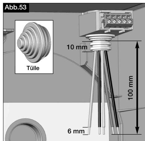
Das Anschlusskabel ist so zu verfahren, dass bei Wasserbeaufschlagung kein Wasser entlang des Kabels eindringen kann. Das Kabel darf nicht über scharfe Kanten geführt werden!
