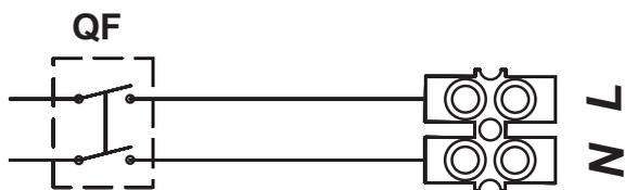
QF - automatischer Sicherungsautomat
