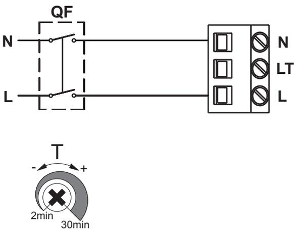
QF - automatischer Sicherungsautomat
