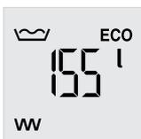
Angezeigt wird die aktuell verfügbare Mischwassermenge von 40 °C bei 15 °C Kaltwassertemperatur.
