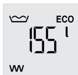
Het momenteel beschikbare mengwatervolume van 40 °C wordt aangegeven bij 15 °C koudwaterinlooptemperatuur.
