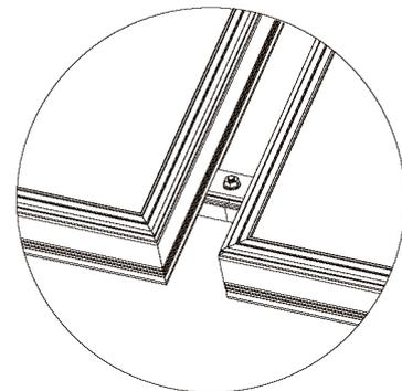
5. Seitlich werden die Kollektoren mit einer Kappe (6) und Schrauben (10) montiert (10).
