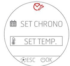
Wird mit der Programmierung fortgefahren, wird der für dieses Zeitintervall gewählte Modus und dann die Ventilation eingestellt. Es ist zu beachten, dass die Ventilation nur gewählt werden kann, wenn die Betriebsart AUTO programmiert ist. Wenn im Feld der Ventilation  $\otimes$  der Modus COMFORT oder OVERNIGHT gewählt wurde, werden Striche - - - angezeigt und es besteht keine Möglichkeit zur Änderung.
