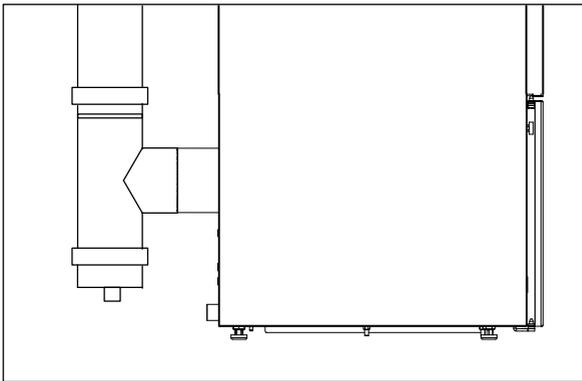
Nach dem Abnehmen der Seitenplatte die Rauchgasleitung reinigen. Die Schraube „x“, den Verschluss „p“ und die Dichtung „g“ entfernen. Dann das Innere des Rauchgaskastens reinigen, alle Bauteile wieder montieren und bei Bedarf die Dichtung „g“ austauschen.
