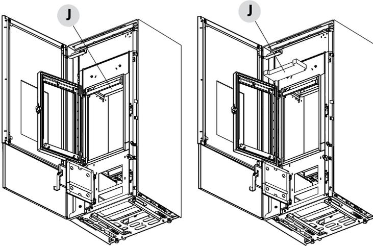
Mit einer starren Stange oder einer Flaschenbürste die Wände der Brennkammer (siehe Pfeile - jeweils rechts und links des Brennkammer) abkratzen, sodass die Asche in das Fach darunter fällt.
