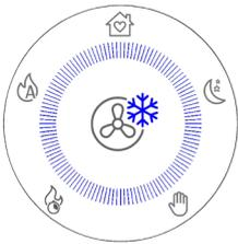
Wenn das Gerät eine große Anzahl von Stunden (z. B. 6 Stunden) ununterbrochen mit maximaler Leistung in Betrieb ist (was gemäß den Warnhinweisen in Kapitel 1 von „TEIL 1“ des Handbuchs nicht empfohlen wird), wird ein zwingend durchzuführender Kühlzyklus von 30 Minuten ausgelöst. In diesem Fall erscheint auf dem Display die nebenstehende Anzeige.
