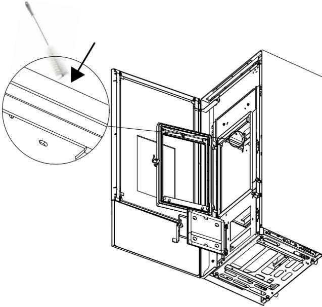
Anschließend auch den unteren Wärmetauscher noch einmal gründlich reinigen, ggf. die Dichtungen austauschen und alles wieder zusammenbauen.
