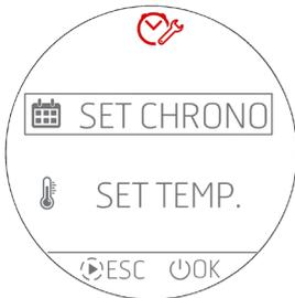
Zum Einstellen der Temperaturen SET T1 - T2 - T3 - T4 (T3 und T4 nur bei Hydro-Öfen) muss das Menü **SET TEMP** aufgerufen werden, indem der Menüpunkt mit den Tasten  $\oplus$   $\ominus$  ausgewählt und mit der Taste  $\odot$  OK bestätigt wird.
