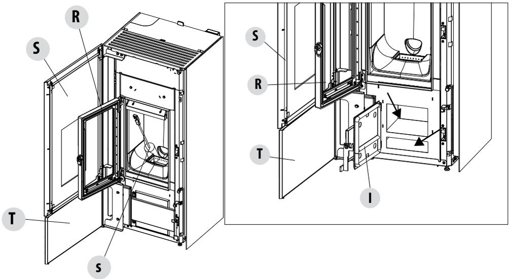
Zum Entfernen eventueller Rückstände wird empfohlen, die Feuerzone mit einer Bürste „s“ (im Lieferumfang enthalten) gründlich zu reinigen. Nach Abschluss dieser Tätigkeit sollte ein Staubsauger verwendet werden, um die Rückstände zu entfernen.
