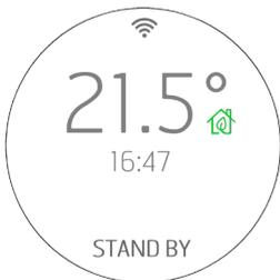
Wenn die Raumtemperatur die eingestellte Temperatur erreicht hat und auch alle anderen Parameter eingehalten werden (siehe nächster Abschnitt), schaltet sich das Gerät ab und auf dem Display werden die Raumtemperatur, die aktuelle Uhrzeit und die Anzeige STANDBY angezeigt, um den Betriebszustand Standby anzuzeigen, der es dem Gerät ermöglicht, sich wieder einzuschalten, sobald die Temperatur unter den eingestellten Schwellenwert sinkt oder wenn die gewünschte Raumtemperatur erhöht wird.
