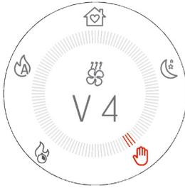
Mit der Taste
