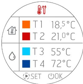
Durch Drücken der Taste  $\blacktriangleright$  SET wird die erste Temperatur (T1) ROT und mit den Tasten  $\oplus$   $\ominus$  kann man in 0,5 °C-Schritten Änderungen vornehmen. Gewöhnlicherweise führt ein längeres Drücken der Tasten  $\oplus$   $\ominus$  zu Temperaturänderungen in größeren Schritten, die der gleichen Systematik folgen wie die Temperaturänderungen auf dem Bedienfeld.
