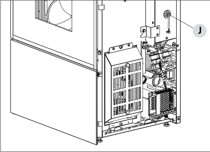
Der Pellet-Sensor ist ein Anzeiger für die Brennstoffreserve, der dazu dient, dem Benutzer zu melden, dass die Pellets fast verbraucht sind.
