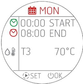
Im Vergleich zu den luftgeführten Geräten AIR gibt es weniger Einstellmöglichkeiten, nämlich nur START, END und die Temperatur des Wassers im Kessel/Puffer/Boiler.
