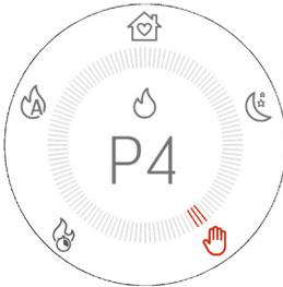
Die Tasten ermöglichen die Änderung der Flammenleistung und wenn die Tasten gedrückt werden, verschwinden alle Texte in der Mitte des Displays, um nur die laufende Einstellung anzuzeigen.
