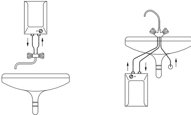
Vor Anschluss an das Elektronetz ist der Warmwasserbereiter unbedingt mit Wasser zu füllen. Bei der ersten Füllung öffnen Sie den Warmwasserlauf der Mischbatterie. Der Warmwasserbereiter ist voll, wenn Wasser aus dem Auslaufrohr der Mischbatterie läuft. Wenn Sie versäumen, den Warmwasserbereiter beim Anschluss mit Wasser zu füllen, wird beim ersten Gebrauch die Heizsicherung beschädigt und der Warmwasserbereiter funktioniert nicht.
