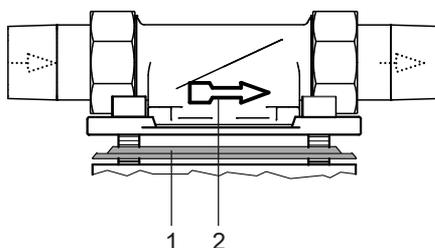
Abb. 2: Einbaudrehflansch
