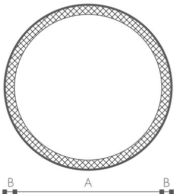
CLIMAFLEX® STABIL ABFLUSS für Abwasserleitungen reduziert die Geräuschbelastung durch Fließgeräusche.
