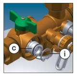
Der Rückflussverhinderer (RV) sitzt in der Kugel der Absperrung 1 (a).
