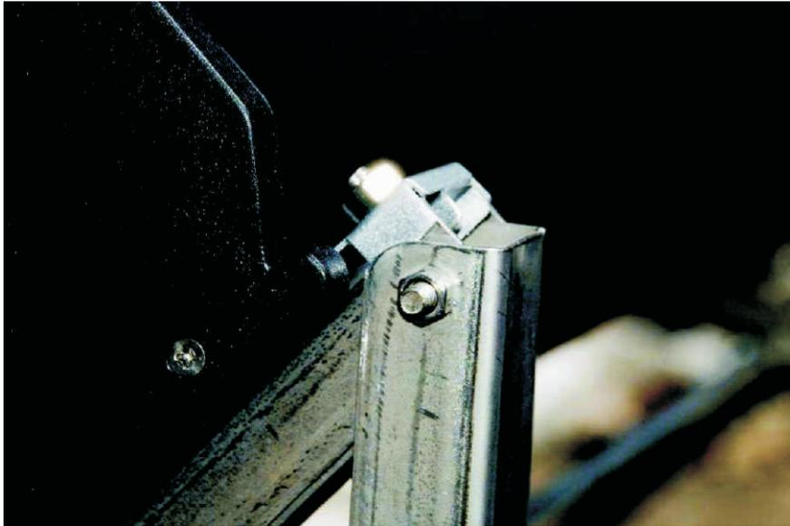
Die Vakuumrohr Halterung ⑫ anbringen.
