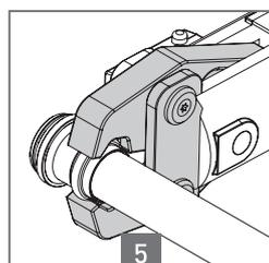
Die Fittings sind mit den Pressbacken der Systeme Typ -M- oder -V- Kompatibel und sind nach DVGW zertifiziert.
