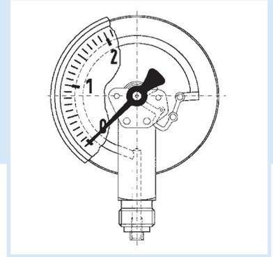
**Anwendung** Für gasförmige und flüssige, nicht hochviskose und nicht kristallisierende Medien, die Kupferlegierungen nicht angreifen. Für Messstellen mit starken Vibrationen und hohen dynamischen Druckbelastungen.
