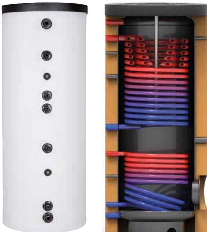
Indirekt beheizter Warmwasser-Standspeicher mit einem doppelt gewickelten Hochleistungswärmetauscher oben und einem Wärmetauscher unten. Besonders für den Einsatz mit Wärmepumpen und Brennwertwärmerezeuger geeignet in Verbindung mit Solaranlagen.
