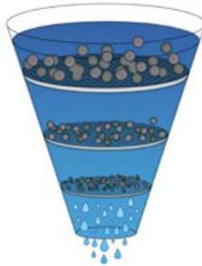
Mechanische Partikelfilterung mit hohem Wirkungsgrad ( $\beta$  200) mit einem speziell für AdBlue® entwickelten Inkrementalfilter.
