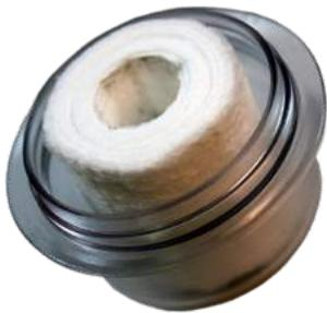
Typischer Filterzustand nach 3650 Litern Abgabe. Wir empfehlen, die Filterkartusche einmal pro Jahr auszutauschen.
