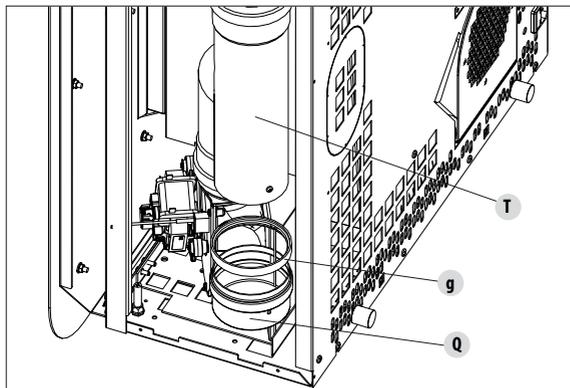
Nach dem Abnehmen der Seitenplatten die Rauchgasleitung reinigen.
