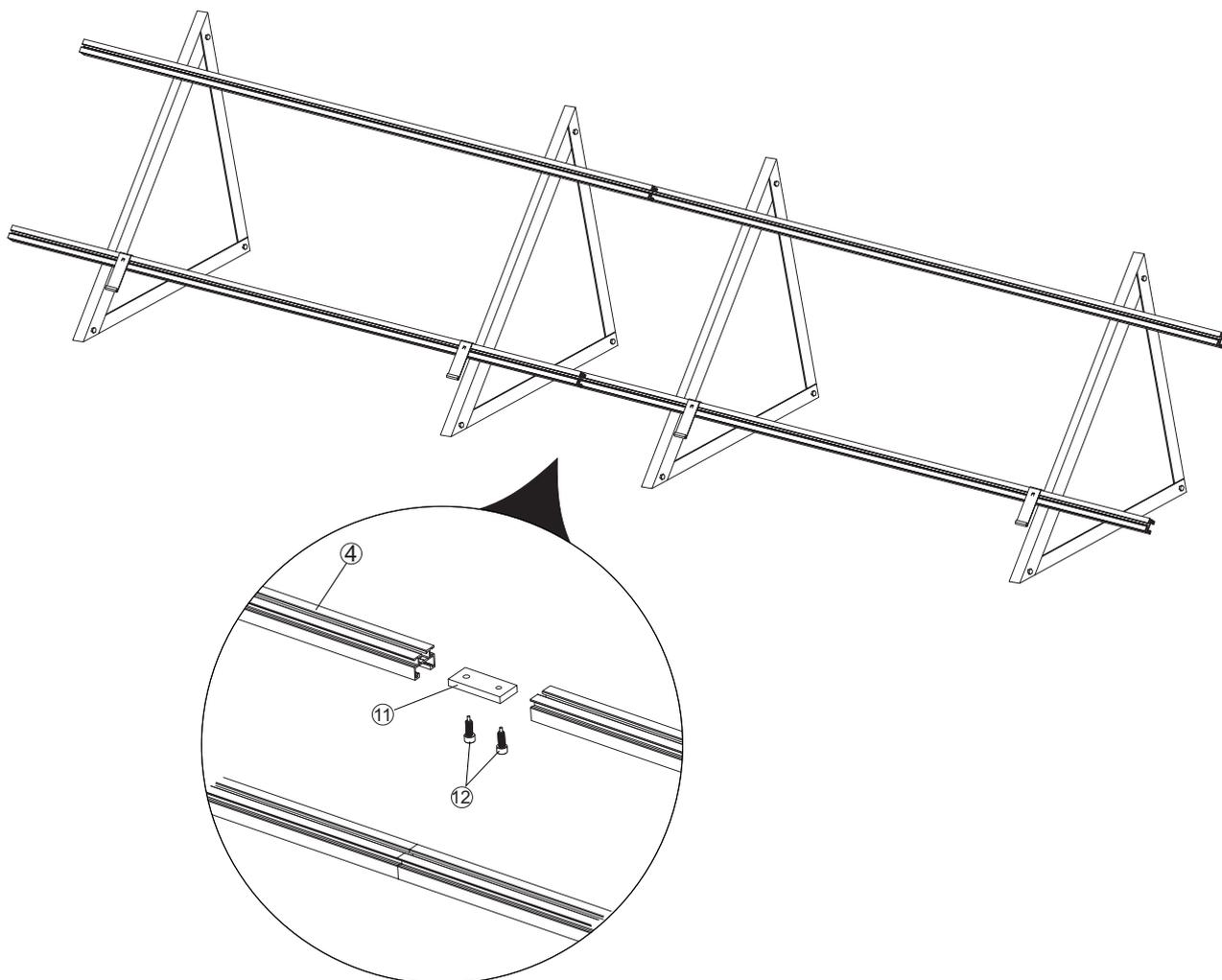
Das Anschlussprofil ① in das Aluminium Profil ④
