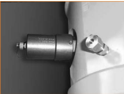
Abb. 7: MQM Quantometer mit HF-Sensor
