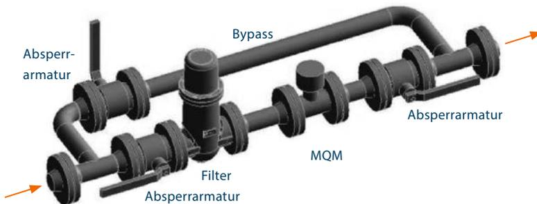
Abb. 2: Typische horizontale Installation des MQM Quantometers (empfohlen)
