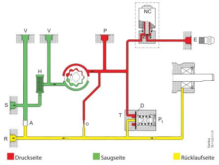
Über den Sauganschluss (S) wird das Öl über das Filter (H) in den Zahnradsatz gesaugt, wo der Druck erhöht wird. Wenn Spannung an das NC-Ventil (normally closed) gelegt wird, öffnet es und gibt das Öl zur Düse frei.
