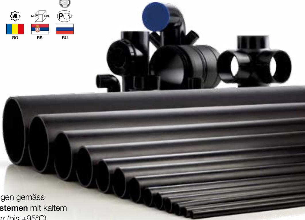
Valsir HDPE erfüllt die Anforderungen gemäss EN 1519 und kann **für Abflusssystemen** mit kaltem (bis  $-40^{\circ}\text{C}$ ) und heissem Abwasser (bis  $+95^{\circ}\text{C}$ ), für Lüftungsleitungen von Abflusssystemen und für Regenwasserfallleitungen **in Wohngebäuden, Gewerbegebäuden, Hotels und dank der hervorragenden Chemikalienbeständigkeit auch in Krankenhäusern und Laboratorien** eingesetzt werden.
