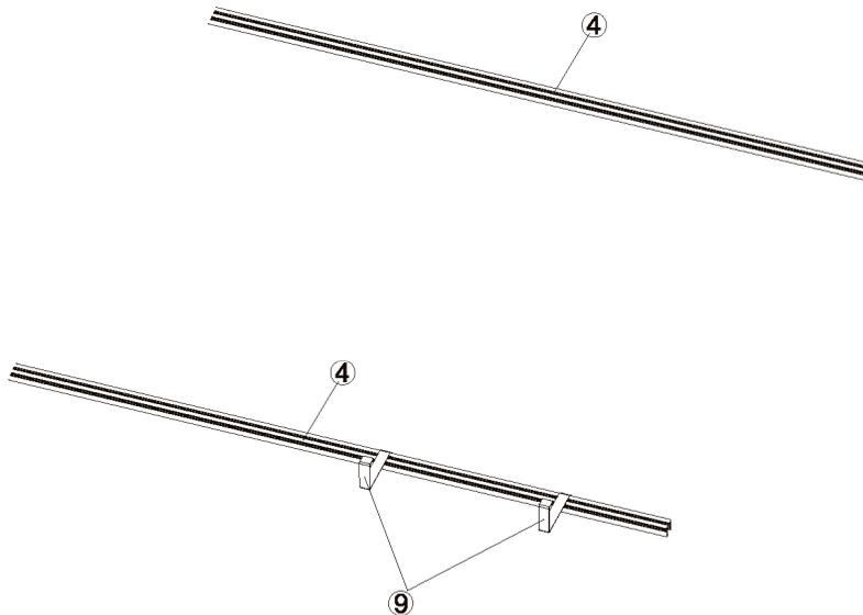
3. Die auf den Bügeln gelegten Kollektoren (9) werden mit einer Kappe (5) und Schraube (10) montiert nach vorherigem Herunterrutschen.
