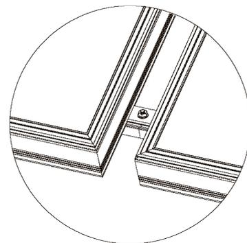
5. Seitlich werden die Kollektoren mit einer Kappe (6) und Schrauben montiert (11).
